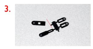
Diesen Adapter trennen Sie einfach mit einem Seitenschneider o.ä. von der Platine ab. Dieses Foto zeigt die Platine "von unten".
